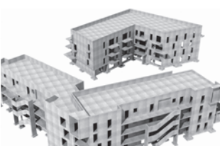
STRUCTURE BÉTON 3D RÉALISATION IBATEC
